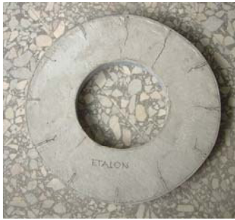
3. ábra Egy szálerősítés nélküli „etalon” próbatesszt a vizsgáló gyűrűben. Jól megfigyelhetők a keletkezett zsugorodási repedések
