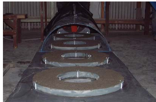
2. ábra Forszírozott szárítás a repedésképződési hajlam vizsgálatára
